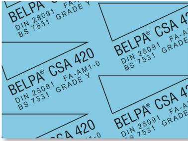
Material comprimido para juntas de altas prestaciones fabricado a base de fibras minerales, aramida y cargas inorgánicas dispersas en una matriz de caucho tipo NBR de alta calidad.
