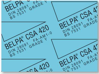
Feuille comprimée sans amiante fabriquée avec un mélange de fibres de haute résistance thermique et mécanique plus une base d'élastomère NBR. Le matériel ainsi obtenu est une feuille pour les services généraux avec une haute résistance mécanique et thermique ainsi qu'une perméabilité basse et un stress résiduel respectant la norme BS7531 (Grade Y).
