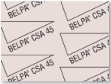
Feuille comprimée sans amiante fabriquée avec des fibres minérales, renforçant une formulation d'élastomères de base NBR. On obtient ainsi une feuille pour joints avec une bonne gamme d'applications de basse à moyenne pression. Sa résistance aux huiles et sa basse perméabilité au gaz font de cette feuille un produit sans amiante pour la majorité des usages généraux (eau, air, huiles et solvants, etc.). Matériau conçu pour son emploi avec de l'eau, air, gaz et huiles dans des conditions modérées.
