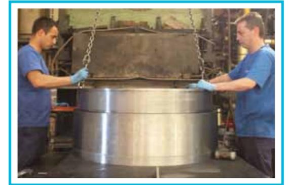
Conformado de Junta Pressure Seal
